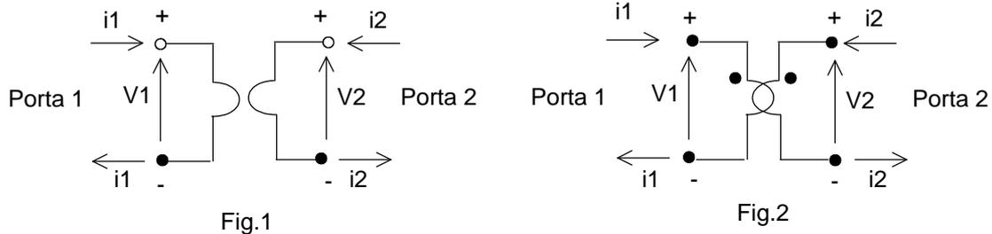
**Definizione:** il trasformatore ideale è un componente elettronico formato da 4 poli, riuniti in due porte.
