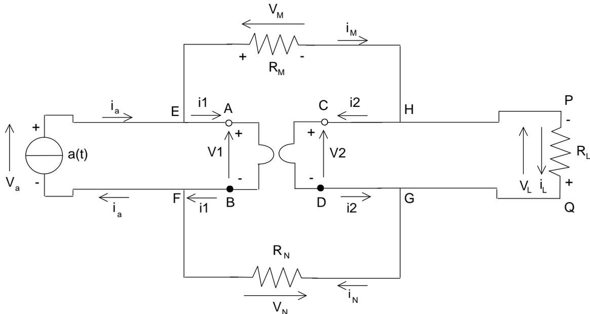
Considero il circuito rappresentato in figura. Tra la porta 1 e la porta 2 sono state inserite due resistenze, che assumono il ruolo di Resistenze a Ponte.
